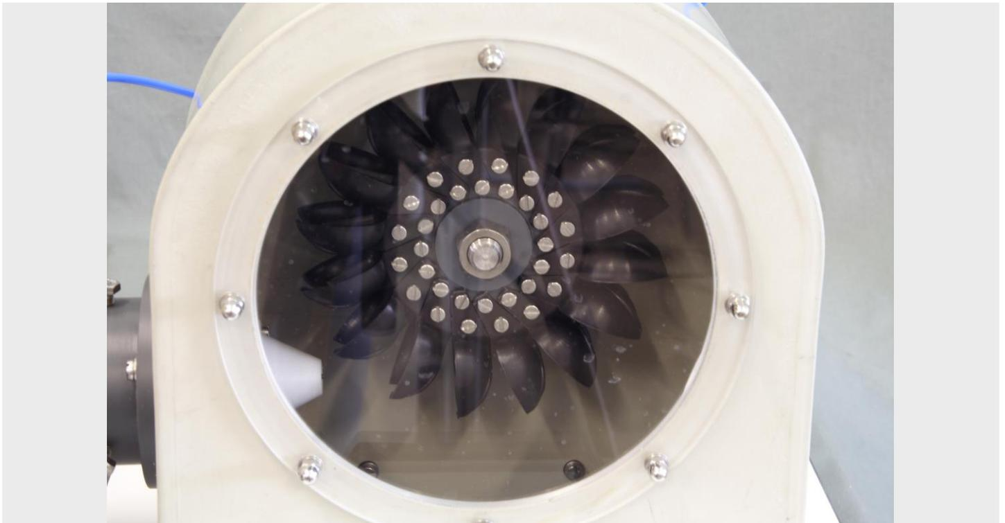
Gracias a su frontal transparente, se puede apreciar perfectamente como el agua que sale por el inyector golpea contra las palas y como, en función de la velocidad de giro, el momento en que el agua sale de la pala se aldea o retrasa, en función de la velocidad relativa del agua respecto a la del rodete.
